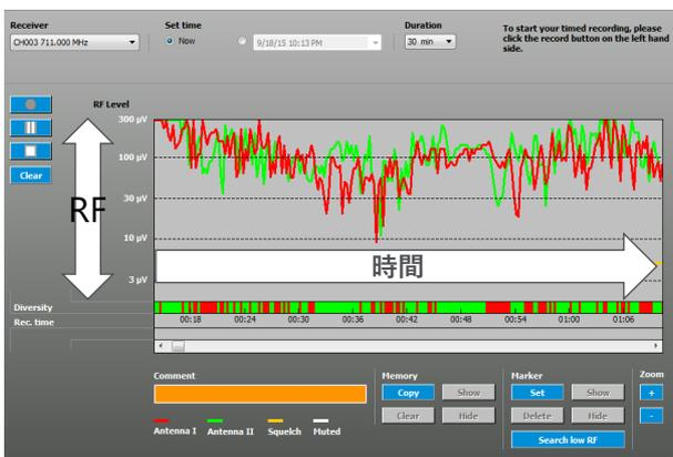
受信機に接続しているアンテナの受信レベルをグラフで表示
