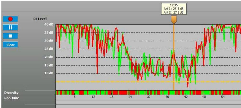
電界強度“RF Level”の測定値は、定義された測定期間にわたって色付きのバーとして表示されています。最大40 dBの最大の電界強度レベルを表示することができます。
