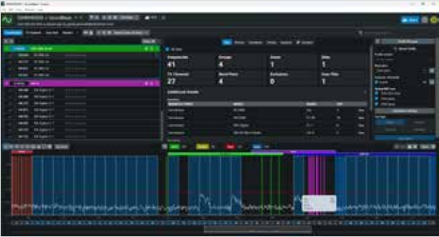
外部アナライザ (tinySA) を使用した電波スキャンと周波数コーディネーション
